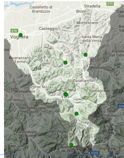
Rete di pluviometri di ARPA Lombardia nell'Oltrepò Pavese (7 stazioni in 800 km<sup>2</sup>)
